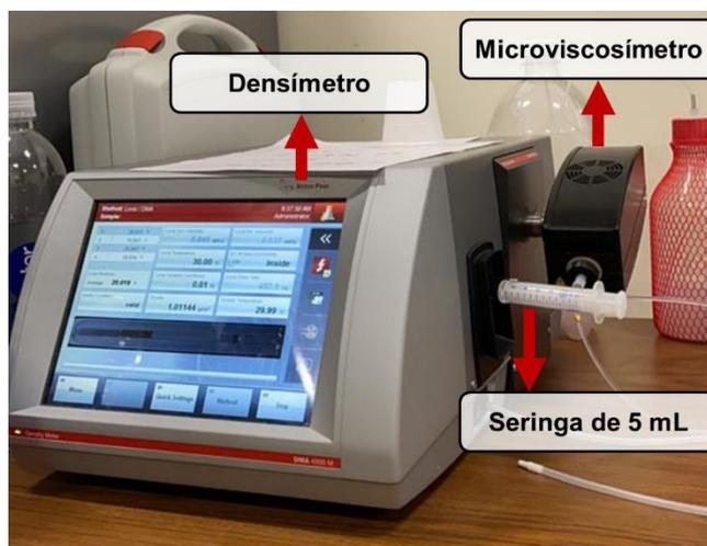
**Figura 2** - Equipamento medidor de densidade e viscosidade.
