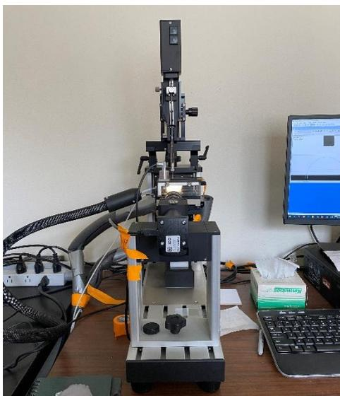
**Figura 3** - Equipamento de medição de tensão superficial e ângulo de contato (OCA 15EC).
