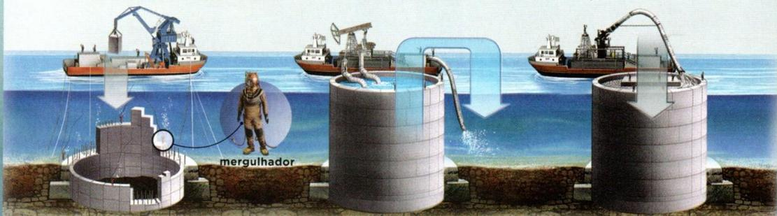
**1.** Blocos de concreto foram baixados e encaixados com ajuda de mergulhadores
