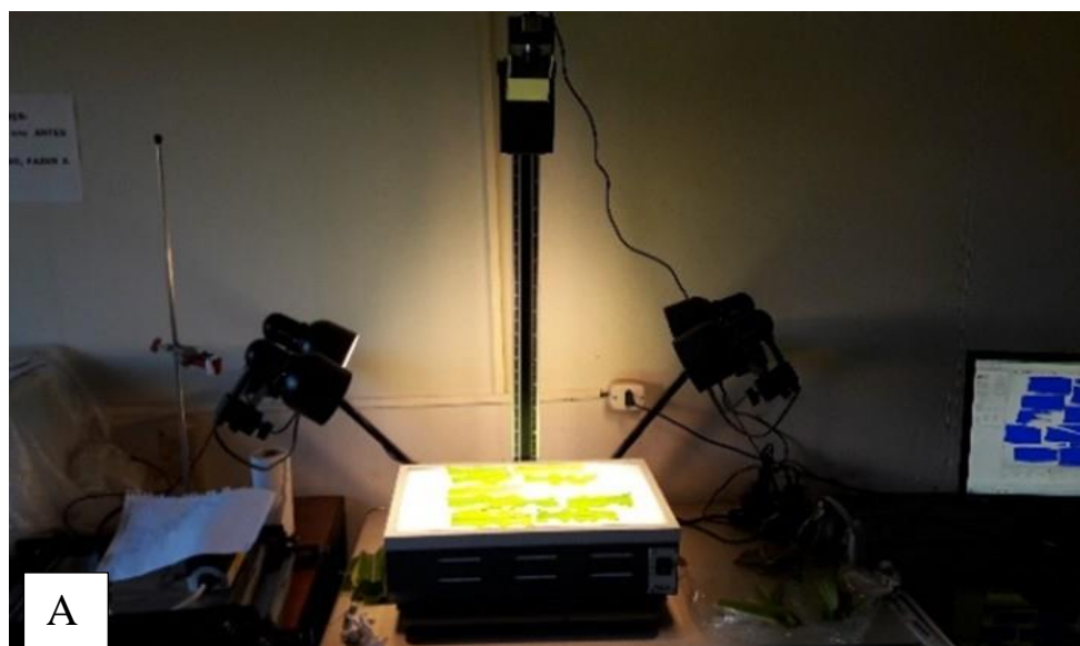
Figura 3. 3 Folhas do híbrido exposta no equipamento WINDIAS 3, após a aplicação no estádio V8 – V9 (A) e leitura do I.A.F do híbrido (B).
