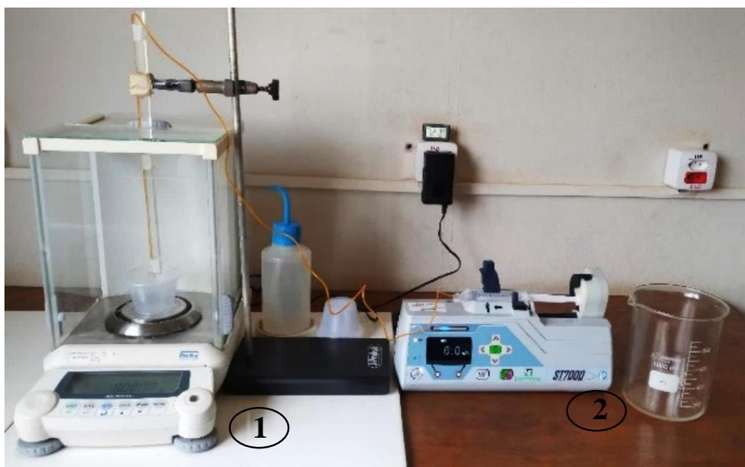
**Figura 6** – Balança de precisão (0,001 g) (1) e bomba de infusão modelo Samtronic ST7000 com fluxo de 6 mL h<sup>-1</sup> (2), utilizada para a determinação da tensão superficial.
